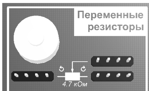
Рис. 6. Блок «Переменные резисторы» (фрагмент)
