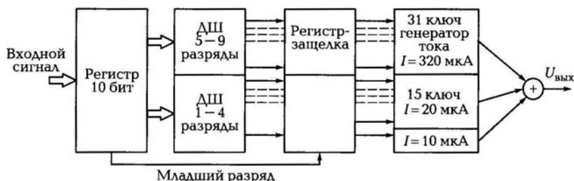
Рис. 7.7. Структура сегментированных ЦАП
