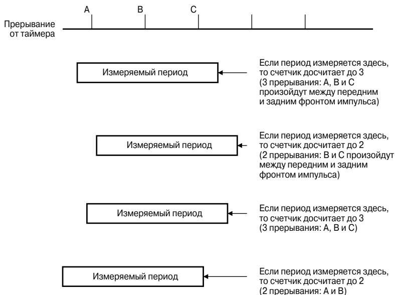
Рис. 4.9. Неопределенность в один такт при измерении длительности сигналов
