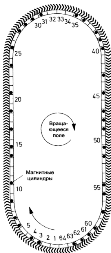
Рис. 12.44. Магнитная дорожка емкостью 64 бита.
