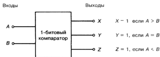
Рис. 11.15. 1-битовый компаратор и его таблица истинности.
