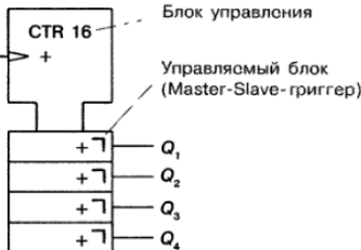
Рис. 10.8. Сборная схема 4-битового двоичного суммирующего счетчика на Master-Slave-триггерах, согласно DIN 40900, часть 12, CTR 16 означает 16 счетных разрядов (CTR — Counter, англ. счетчик).
