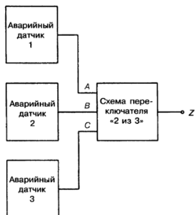
Рис. 5.51. Аварийные датчики и схема переключателя «два из трех».
