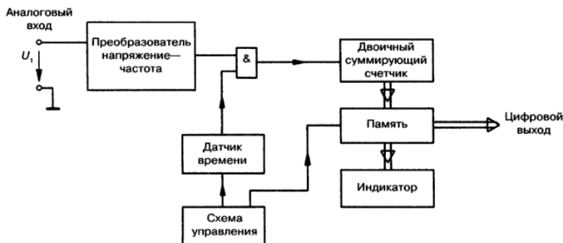
Рис. 13.17. Принципиальная схема АЦП по принципу напряжение—частота.
