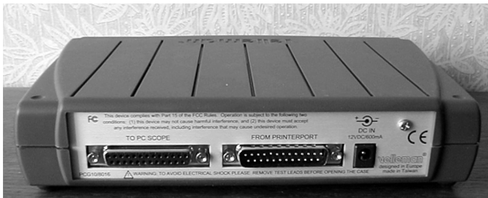
Рис. 3.48. Приставка — функциональный генератор PCG10 (вид сзади)
