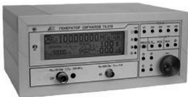
Рис. 1.32. Внешний вид генератора Г4-219
