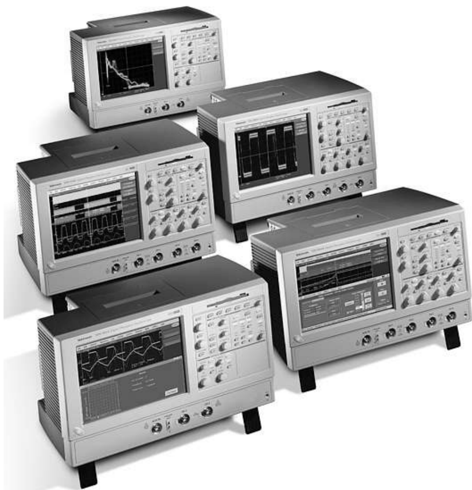
Рис. 5.7. Внешний вид осциллографов с цифровым люминофором серии Tektronix TDS5000B
