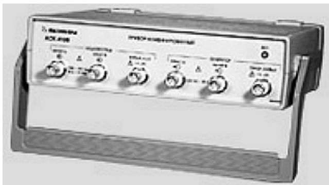
Рис. 3.55. Внешний вид приставки — комбинированного прибора АСК-4106
