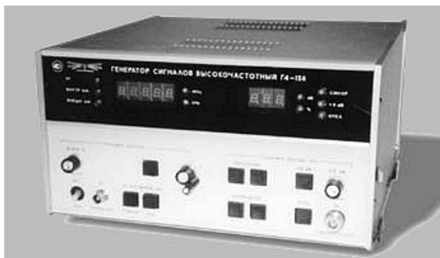
Рис. 1.31. Современный ВЧ ГСС Г4-158А
