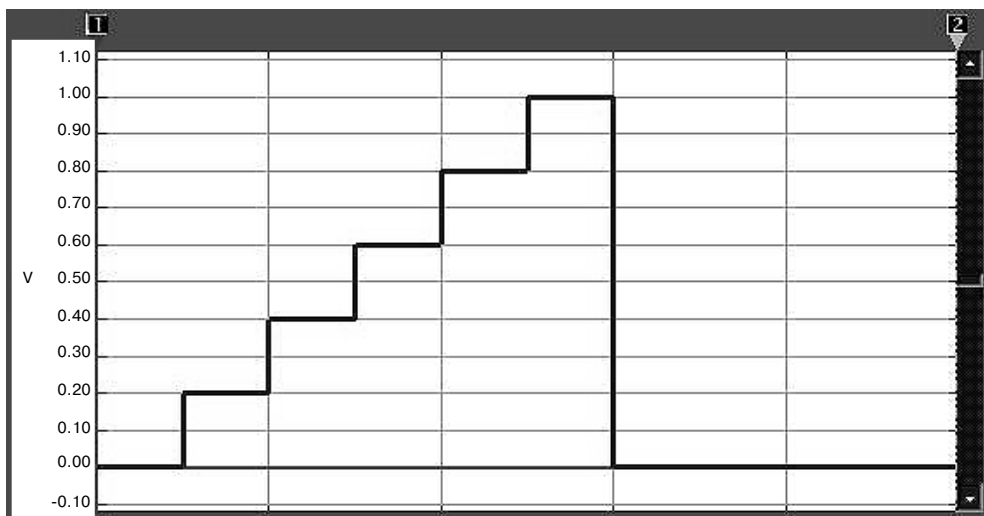
Рис. 4.40. Лестничный сигнал с пятью ступеньками
