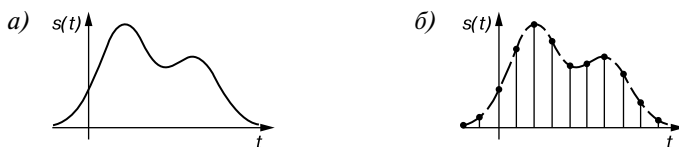
Рис. 1.29. Синтезированный сигнал в идеале (а), его дискретные отсчеты, взятые из памяти (б), и их интерполяция (пунктирная кривая)
