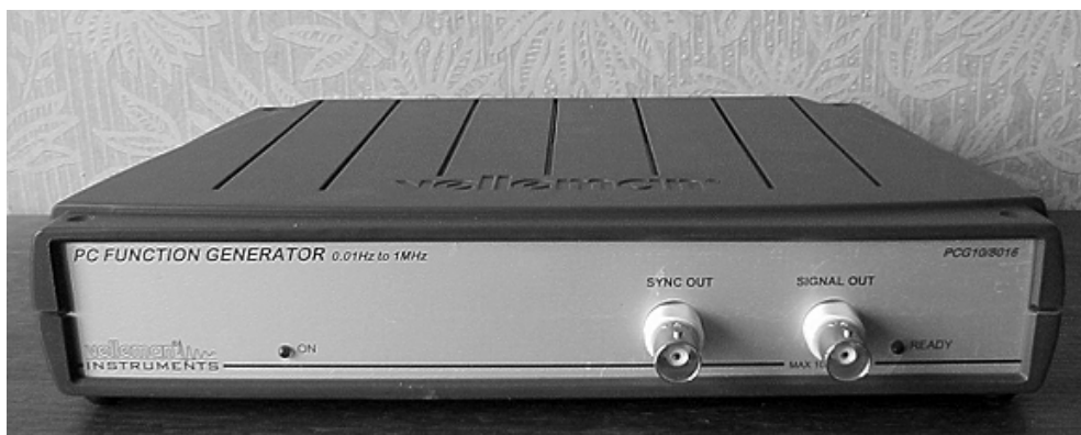
Рис. 3.47. Приставка — функциональный генератор PCG10 (вид спереди)
