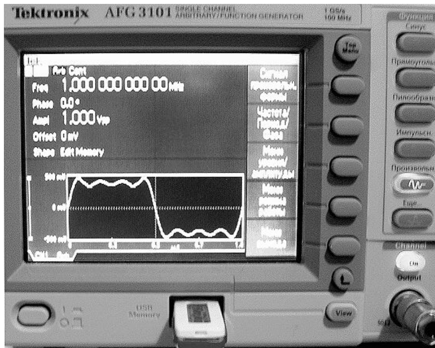
Рис. 4.62. Снимок экрана генератора AFG 3101 с графиком загруженного сигнала
