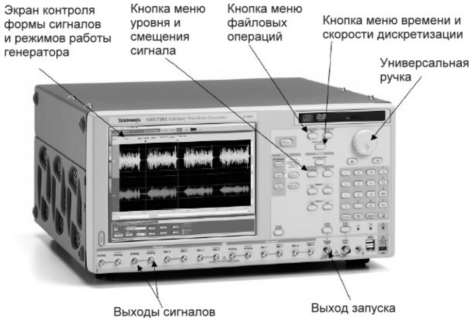
Рис. 4.68. Внешний вид и органы управления генератором AWG7102
