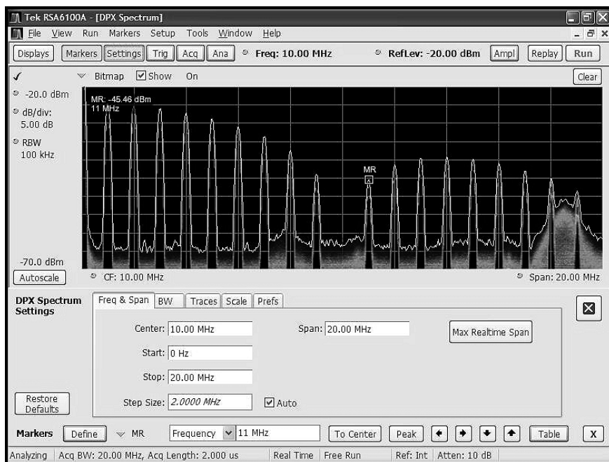
Рис. 5.22. Пример получения DPX спектра (сверху) и вывода панели установки параметров спектрального анализа (снизу)
