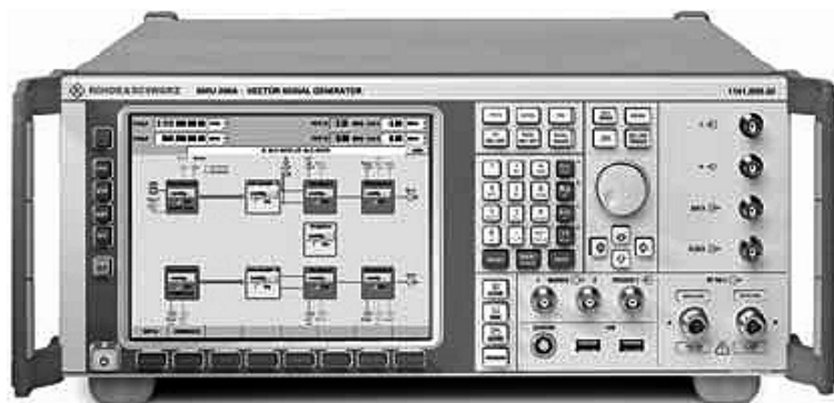
Рис. 1.50. Внешний вид двухканального векторного генератора SMU200A
