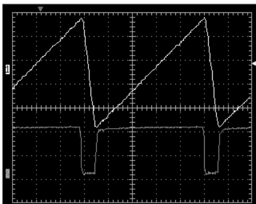
Рис. 3.33. Осциллограммы треугольного и TTL сигналов на частоте 1 МГц с максимальной асимметрией
