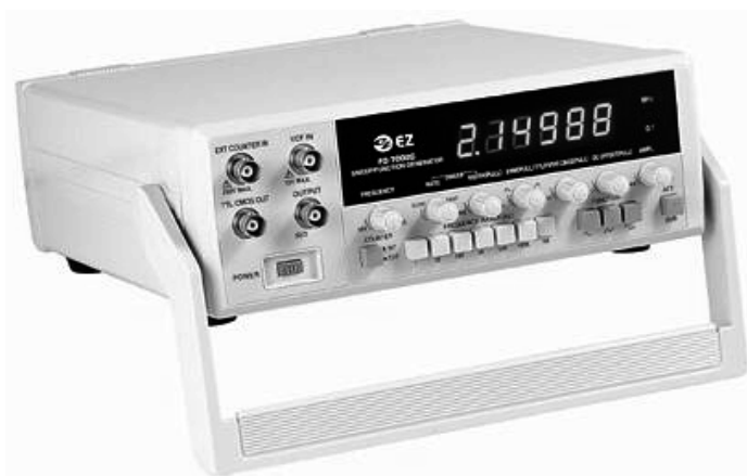
Рис. 3.40. Внешний вид функционального генератора FG-7002C
