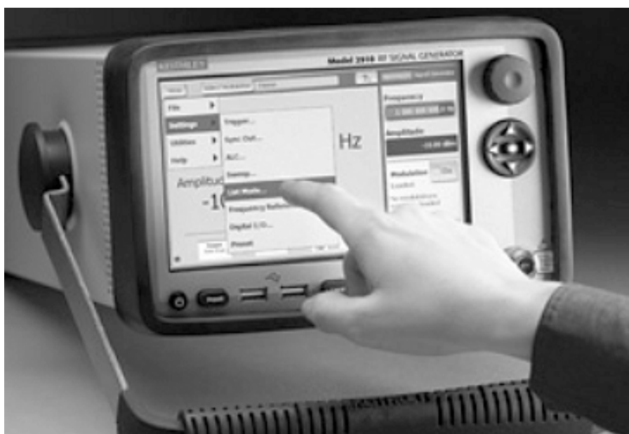
Рис. 1.54. Внешний вид векторного генератора Model 2910 фирмы Keithley
