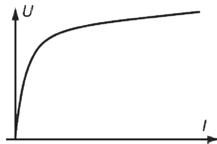
Рис. 2.27. Типичная зависимость напряжения на варисторе от величины тока, протекающего через него
