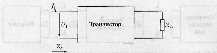
Рис. 2.41. Определение входного сопротивления
