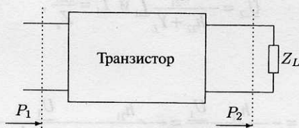
Рис. 2.43. Определение усиления по мощности
