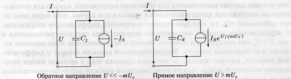
Рис. 1.33. Схема замещения диода в режиме большого сигнала для большого положительного или отрицательного напряжения
