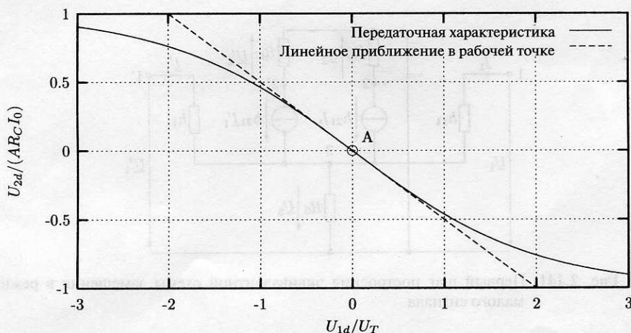
Рис. 2.139. Нормированная передаточная характеристика дифференциального усилителя
