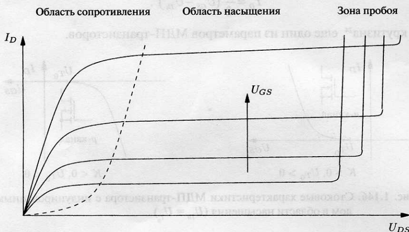
Рис. 1.148. Выходные характеристики n -канального МДП-транзистора
