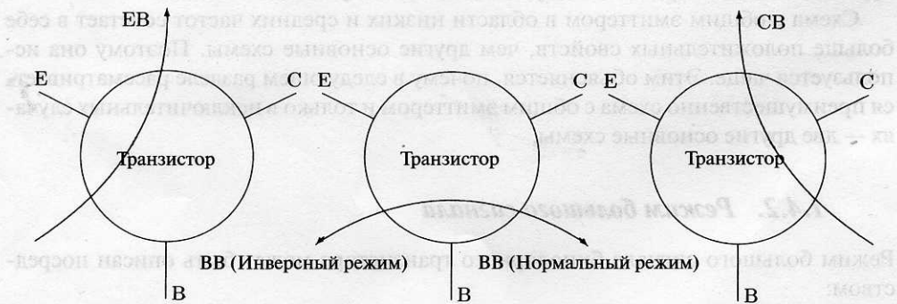
Рис. 1.61. Возможные направления потоков мощности при работе транзистора в режиме усилителя
