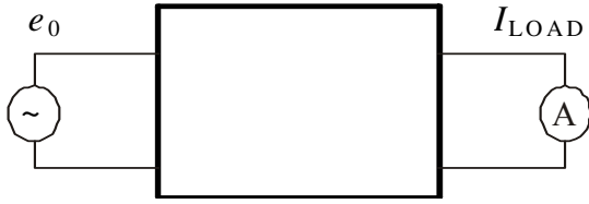
Рис. 2.6. Генератор ЭДС и нагрузка в виде амперметра с нулевым внутренним сопротивлением (к определению свойств взаимного четырехполюсника)
