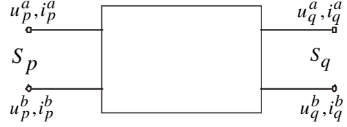
Рис. 2.9. Напряжения и токи от источников a и b на входах p и q четырехполюсника (к выводу теоремы о взаимности)
