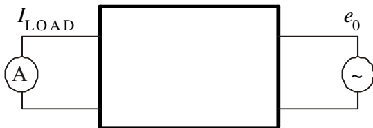
Рис. 2.7. Генератор ЭДС и амперметр переставлены. Если показания амперметра не меняются, четырехполюсник взаимен
