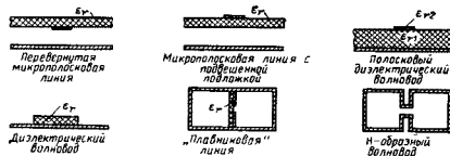
Рис. 3.2. Линии передачи, используемые в СВЧ устройствах менее широко
