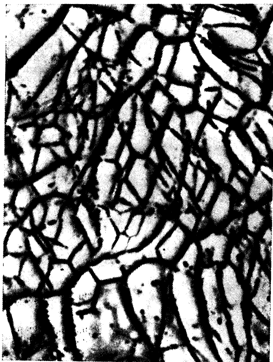
Рис. 9.13. Трехмерная сетка дислокаций в монокристалле AgBr. (По Хиджесу и Митчеллу [5].)
