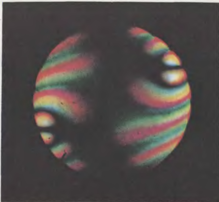
XIV Тот же двуосный крис- талл в сходящемся по- ляризованном свете (николи повернуты на \frac{1}{8} оборота, бóльшее увеличение)
