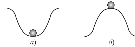
Рис. 7.16. Примеры устойчивого a) (шарик на впадине) и неустойчивого б) (шарик на горке) стационарных состояний
