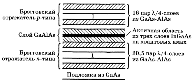
Рис. 9.34 Схематичное представление лазера с вертикальным резонатором и с нижней излучающей поверхностью. Самый верхний слой GaAs имеет толщину, равную половине длины волны, чтобы обеспечить согласование по фазе с металлическим контактом. (Согласно работе [52].)
