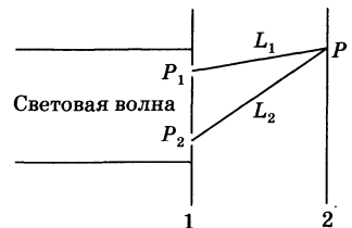
Рис. 11.3 Применение интерферометра Юнга для измерения степени пространственной когерентности электромагнитной волны между точками P_1 и P_2
