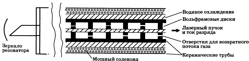
Рис. 10.7 Схематическое изображение мощной Ar^+ -трубки с водяным охлаждением
