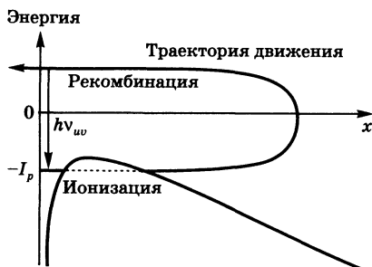
Рис. 12.19 Схема «трехступенчатой» модели возвратного столкновения
