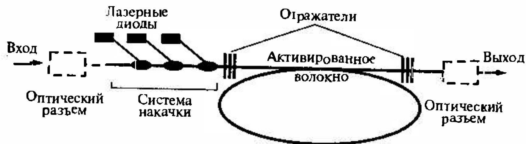
Рис. 8.12. Схема волоконного лазера и лазерного усилителя с диодной накачкой
