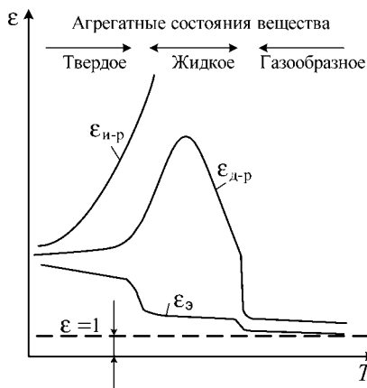
Рис. 6.3. Температурные зависимости диэлектрической проницаемости при электронной \epsilon_э , дипольно-релаксационной \epsilon_{д-р} и ионно-релаксационной \epsilon_{и-р} поляризациях диэлектрика
