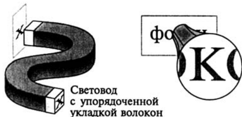
Рис. 7.15. Схема передачи изображения с помощью волоконно-оптического жгута
