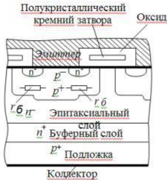
Рисунок 39. Структура IGBT-транзистора.
