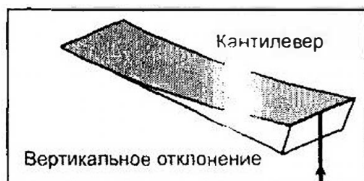
Рис. 7.7. Схема деформации кантилевера в процессе сканирования
