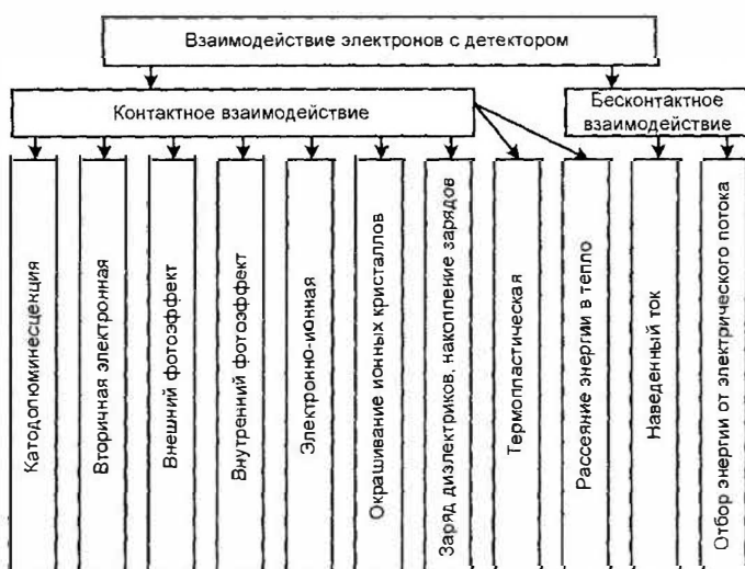
Рис. 3.29. Процессы взаимодействия электронов с веществом детектора
